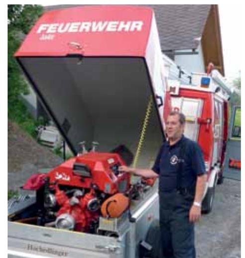
BM Karl Tödting beim Testen der Tragkraftspritze
