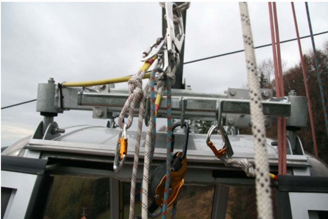
Mittels Abseilgerät (I'D) erfolgt das Abseilen der Passagiere
