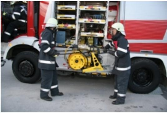
Entnahme des hydraulischen Rettungsgerätes (Schere, Spreizer)
